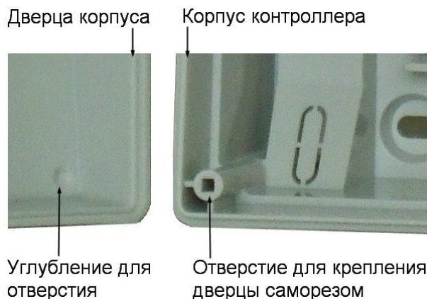
Рисунок 7. Схема «жесткого» крепления дверцы к корпусу
