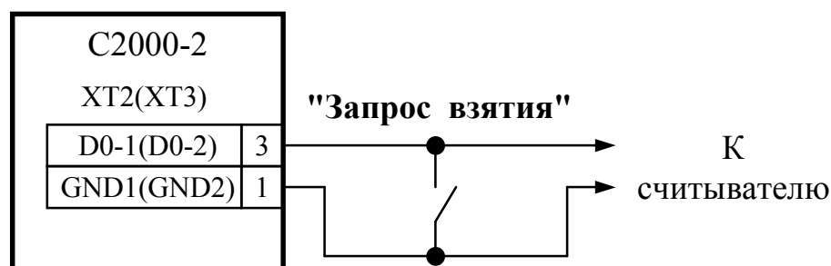
Рисунок 7 Подключение кнопки "Запрос взятия"
