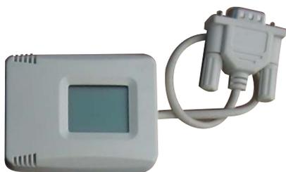
Внешний WEB/SNMP - адаптер - это самостоятельное устройство, совместимое со всеми сериями ИБП INELT, оснащенными портом RS-232.
