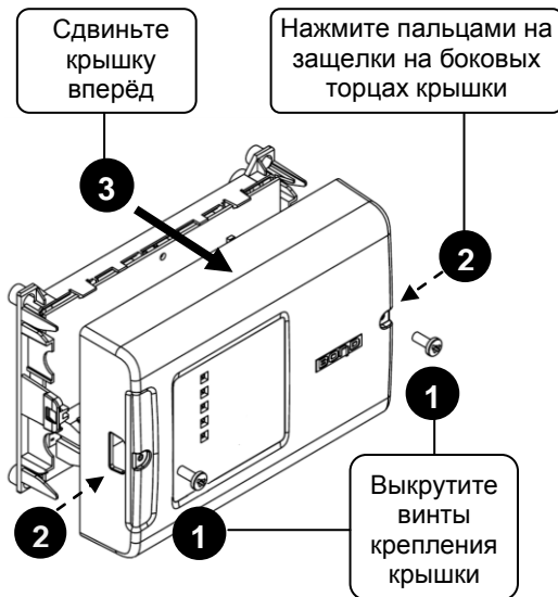
Рисунок 2. Снятие крышки РПИ
