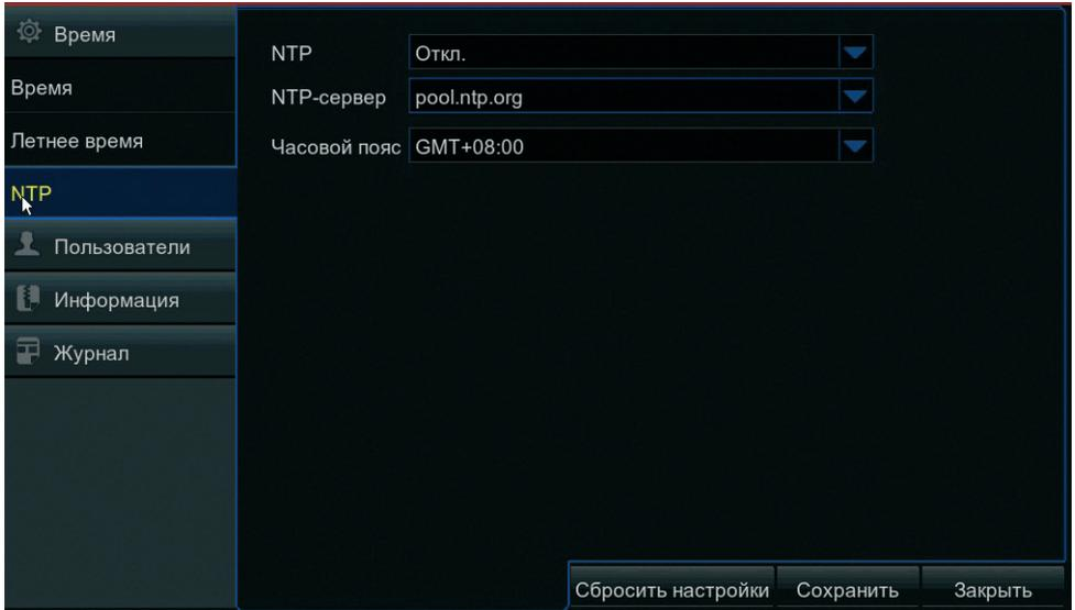
Раздел позволяет выполнить синхронизацию системного времени регистратора с одним из серверов точного времени (NTP): [time.windows.com](http://time.windows.com), [time.nist.gov](http://time.nist.gov) либо [pool.ntp.org](http://pool.ntp.org).
