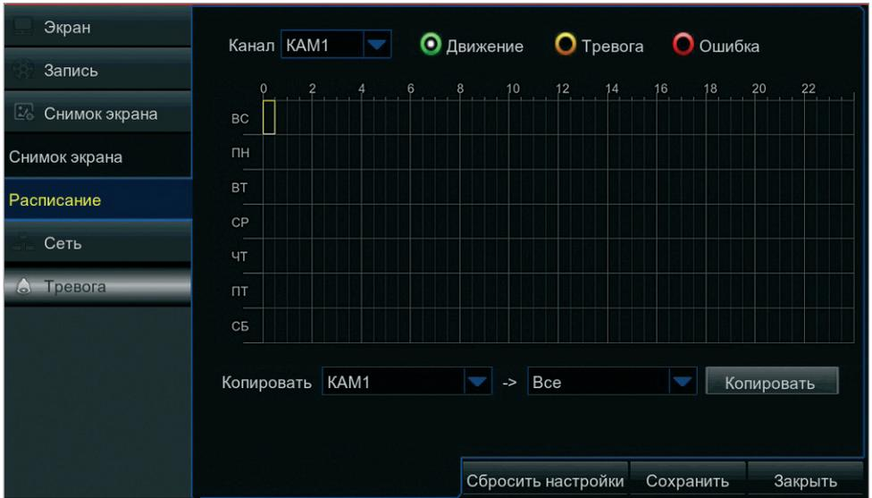
Функция **Снимок экрана** может быть активна постоянно, либо только в определенные дни недели и время. Раздел позволяет настроить расписание для стандартных (регулярных) снимков, а также для снимков, создаваемых при сработке детектора движения или тревожных контактов.
