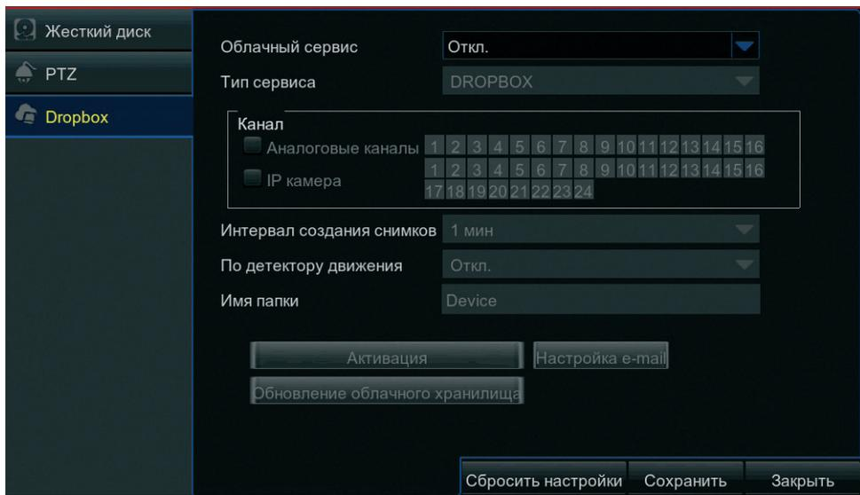
Регистратор может с определенной периодичностью создавать снимки экрана и отправлять их в облачную систему хранения данных Dropbox. Раздел позволяет связать устройство с учетной записью Dropbox.
