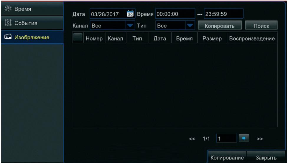
Раздел предназначен для поиска, просмотра и резервного копирования снимков экрана.
