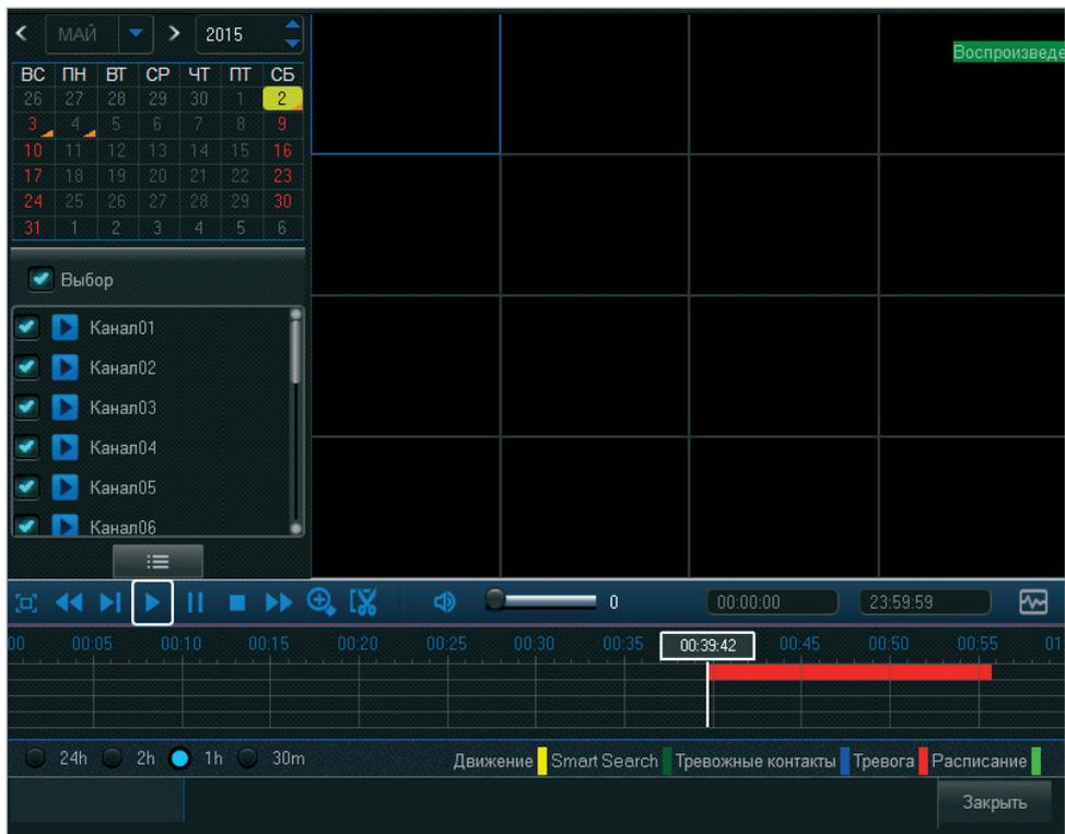
**Smart Search** – функция, позволяющая найти записи, движение на которых присутствует только в определенной области кадра.
