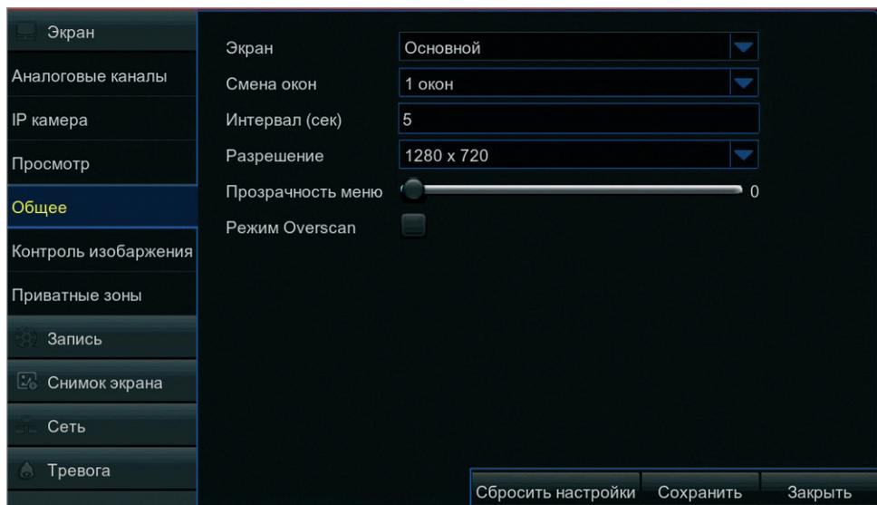
Раздел позволяет выбрать разрешение экрана и настроить режим просмотра видео.
