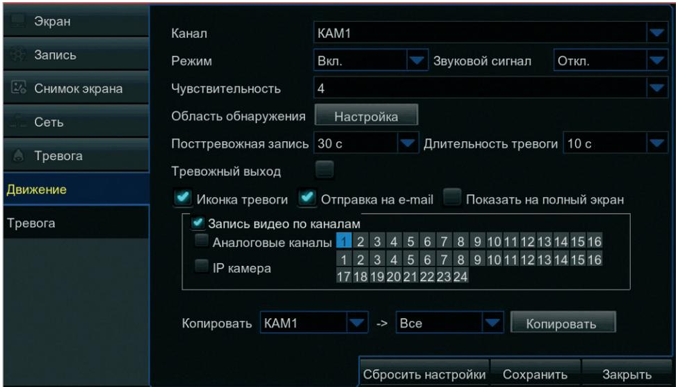
Детектор движения – функция, позволяющая определять наличие перемещения в области обзора камеры и осуществлять запись видео только в те моменты, когда в кадре существует движение, что значительно сокращает объем сохраняемых данных. Раздел позволяет включить детектор движения и настроить его параметры.
