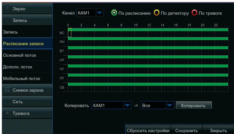
Раздел позволяет настроить расписание регулярной (обычной) записи, записи при обнаружении движения и записи по сигналу, поступившему на тревожный вход.
