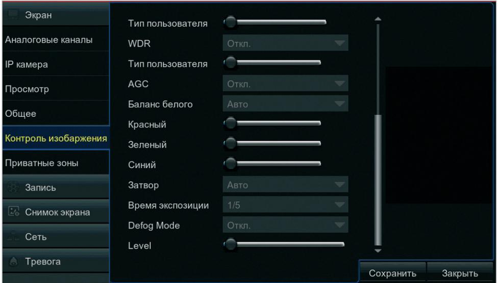
Раздел предназначен для управления такими параметрами IP-камер, как шумоподавление, динамический диапазон (WDR), усиление, баланс белого и т.д.
