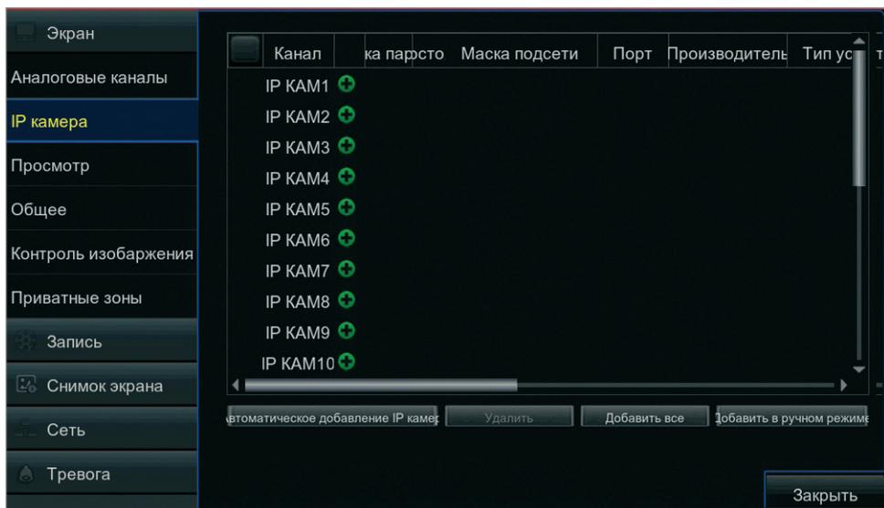
Раздел позволяет подключать IP-камеры к регистратору, а также управлять подключенными устройствами.
