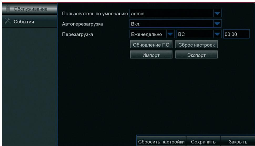
Раздел позволяет настроить параметры автоматической перезагрузки, выполнить сброс настроек, обновить программное обеспечение регистратора, а также создать или загрузить ранее созданный файл конфигурации.
