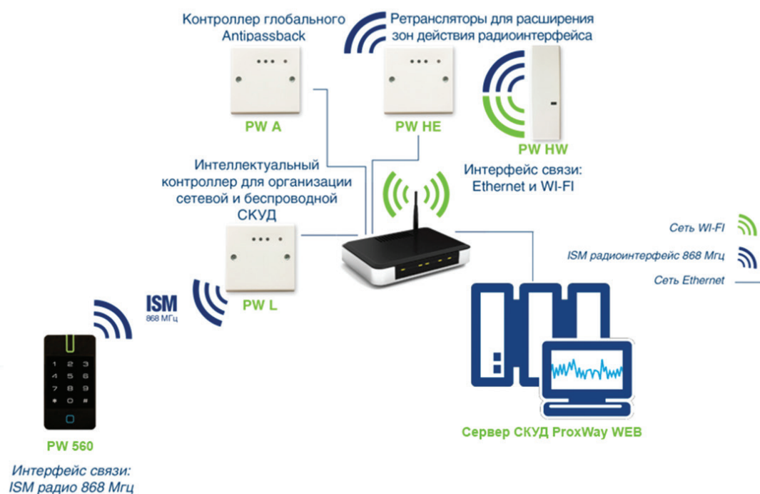
Топология беспроводной сетевой СКУД
