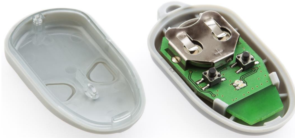
Рисунок 2. Идентификатор со снятой крышкой. Видна батарея питания
