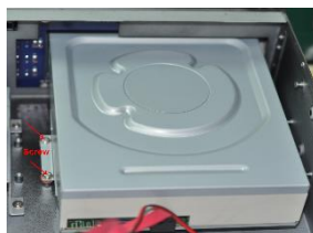
Рис. 2.2 Подключение пишущего DVD
