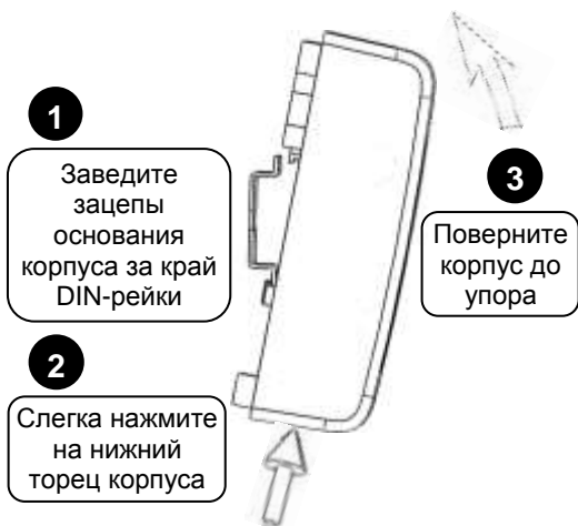
Рисунок 3. Крепление блока на DIN-рейку
