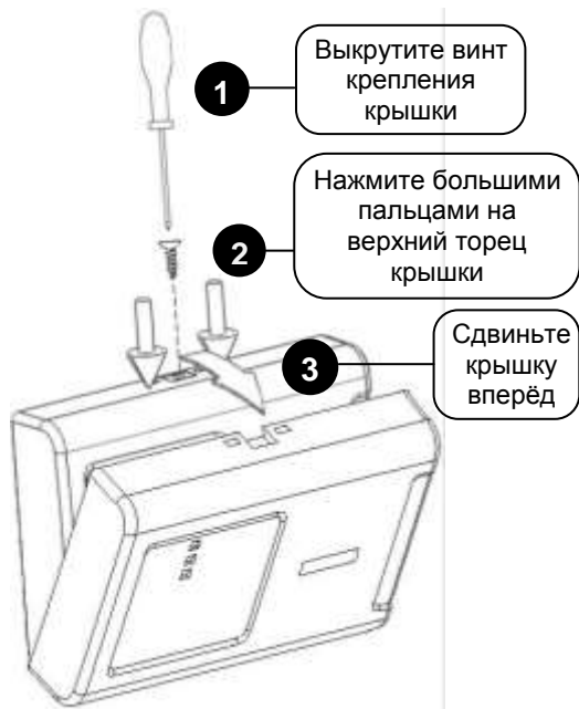
Рисунок 2. Снятие крышки блока
