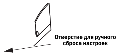
Рисунок 12. Отверстие для ручного сброса настроек
