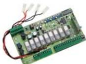
Плата управления с расширенным набором функций для двухстворчатых распашных ворот с возможностью установки платы радиоприемника CAME
