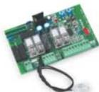
Плата управления для одной створки распашных ворот с возможностью установки платы радиоприемника CAME
