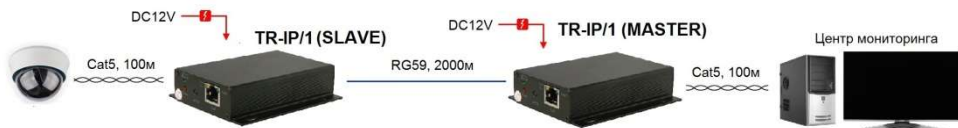
Рис. 5 Схема подключения TR-IP/1(MASTER) и TR-IP/1(SLAVE) для организации видеонаблюдения в лифте.
