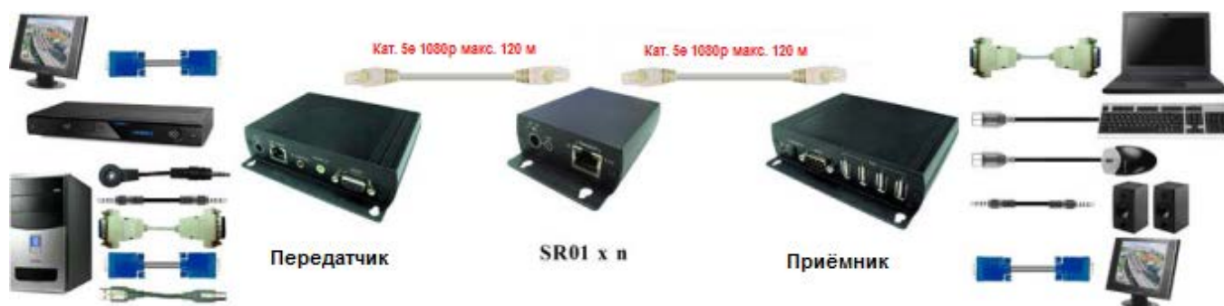
Рис. 5 Схема подключения SR01 совместно с VKM03.
