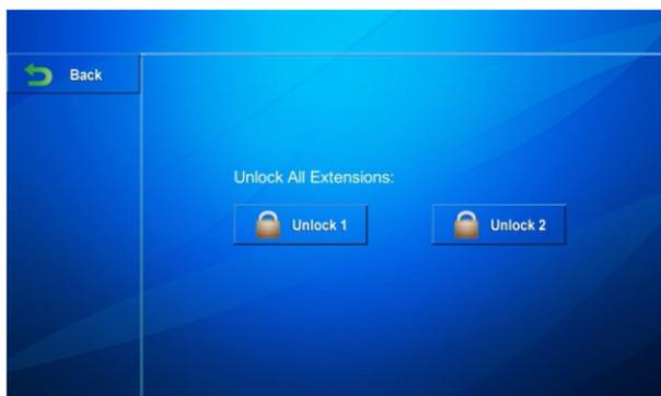
Вы можете одновременно разблокировать двери на всех станциях вызова, как для первого замка так и для второго (Дверь 1, Дверь 2).
