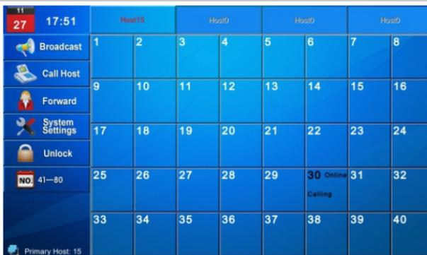
Основное меню: Оповещение, Вызов операторов, Переадресация, Системные настройки, Замки, Переключение рабочих экранов.
