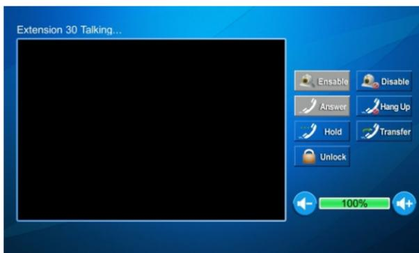
Нажмите «Включить», «Выключить» для включения или выключения камеры; нажмите «Ответить» для ответа на звонок; нажмите «Отбой» для завершения звонка; нажмите «Открыть» для открытия двери.
