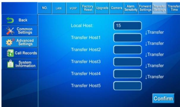
Когда оператор не отвечает на звонок от станции вызова, через заданное время система автоматически переадресует звонок на оператора 2 и далее по списку.
