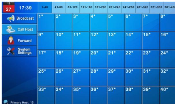
Будут показаны все мониторы оператора. Выберите монитор и нажмите на него. Если монитор онлайн и находится в той же подсети что и Ваше устройство, вызов будет успешным, в противном случае, будет показано сообщение «Соединение неудачно».
