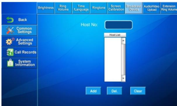
Вставьте номер оператора, который хотите добавить, и нажмите «Добавить». Для удаления, выберите устройство и нажмите «Удалить»; Для очистки списка всех устройств, нажмите «Очистить»
