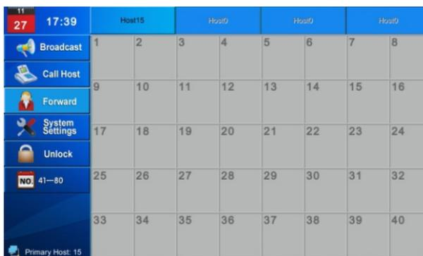
Монитор оператора на который Вы хотите переадресовать вызов, должен быть задан в дополнительных настройках. Если станция совершает вызов после установки переадресации, то вызов будет получен заданным монитором.
