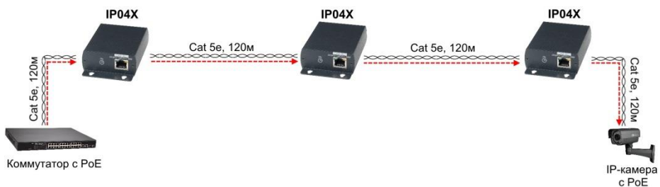
Рис.6 Схема подключения IP04X
