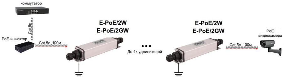
Рис. 3 Схема подключения удлинителей E-PoE/2W, E-PoE/2GW
