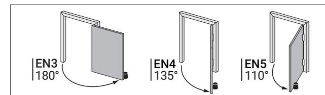
Углы открывания дверного полотна при различной установке согласно шаблону
