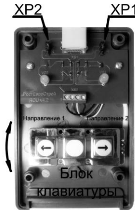
Вид пульта со снятой крышкой
