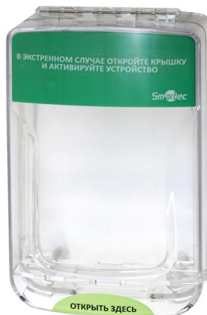
Защитный кожух с откидной крышкой ST-ER100SM предназначен для дополнительной защиты ручных извещателей и устройств разблокировки дверей от неблагоприятного воздействия окружающей среды, а также для предотвращения вандализма или случайной активации. В корпус кожуха может быть установлен звуковой оповещатель, который активируется при открытии крышки защитного кожуха. Кроме того, ST-ER100SM позволяет устанавливать ручные извещатели и устройства разблокировки, как накладным, так и врезным способом.
