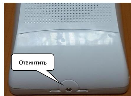
Для включения питания оповещателя удалите (выньтите) бумажную ленту, изолирующую контакт основной батареи оповещателя. Резервная батарея установлена и готова к работе.
