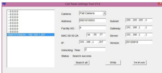
Camera: устанавливается режим работы панели. Режим «Flat Camera» – выбирается для работы адаптера BAS-IP VIZIT в качестве индивидуальной панели, которая будет совершать вызовы на внутренние мониторы.
