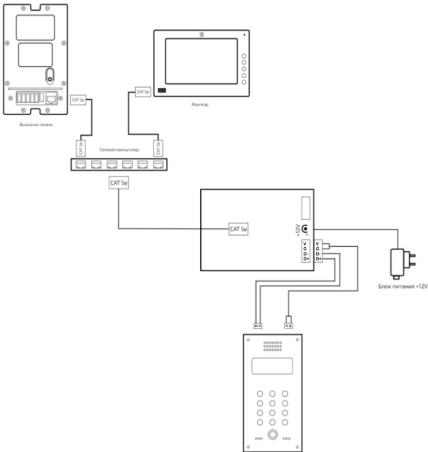
Схема подключения монитора BAS-IP и четырехпроводной
