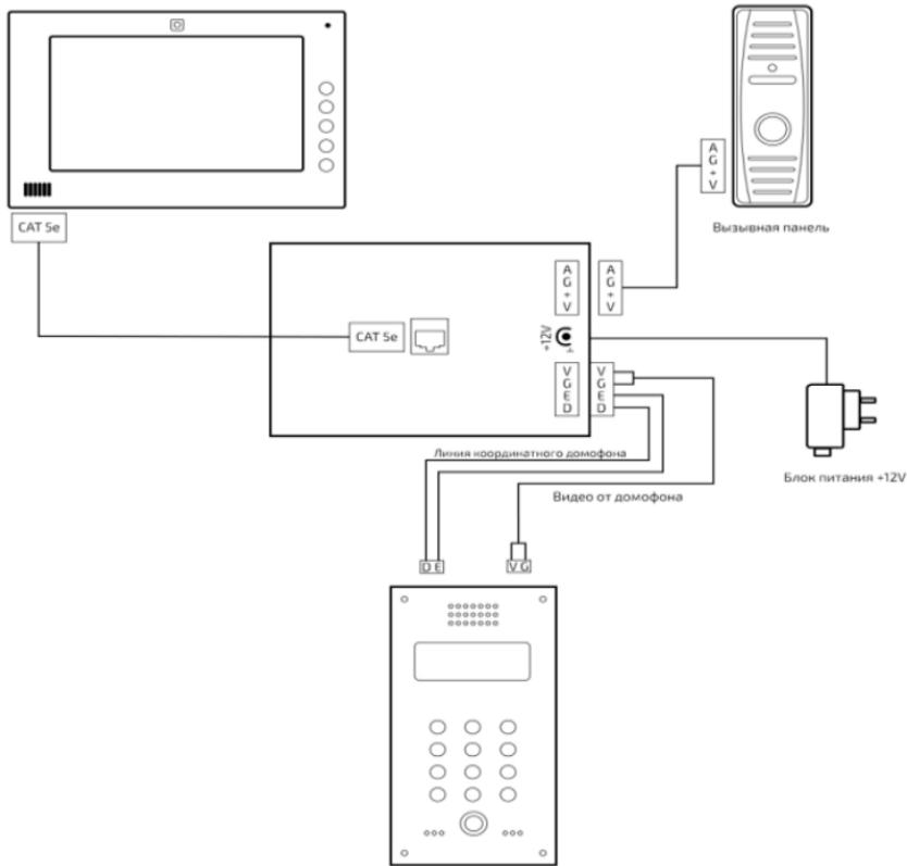
**Схема подключения монитора BAS-IP и вызывной панели BAS-IP к цифровой линии домофона через адаптер CYFRA - BAS-IP**
