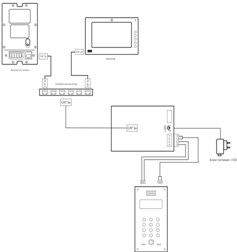
Схема подключения монитора BAS-IP и четырехпроводной вызывной панели к координатной линии домофона через адаптер VIZIT - BAS-IP
