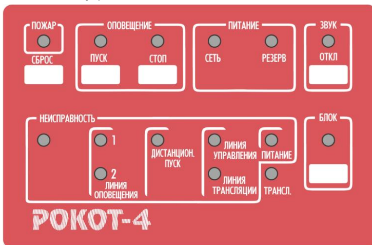
Рис.1 Панель индикации и управления прибора
