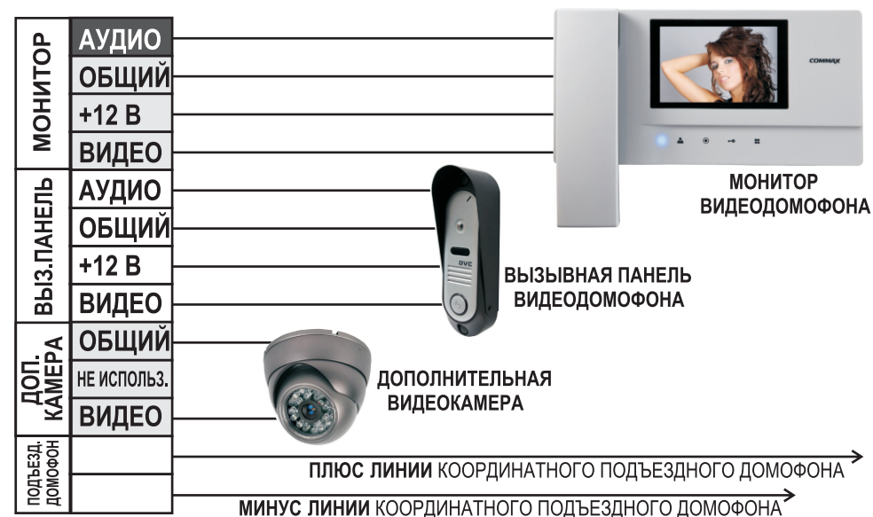
СХЕМА ПОДКЛЮЧЕНИЯ ПЛОСКОГО КАБЕЛЯ
