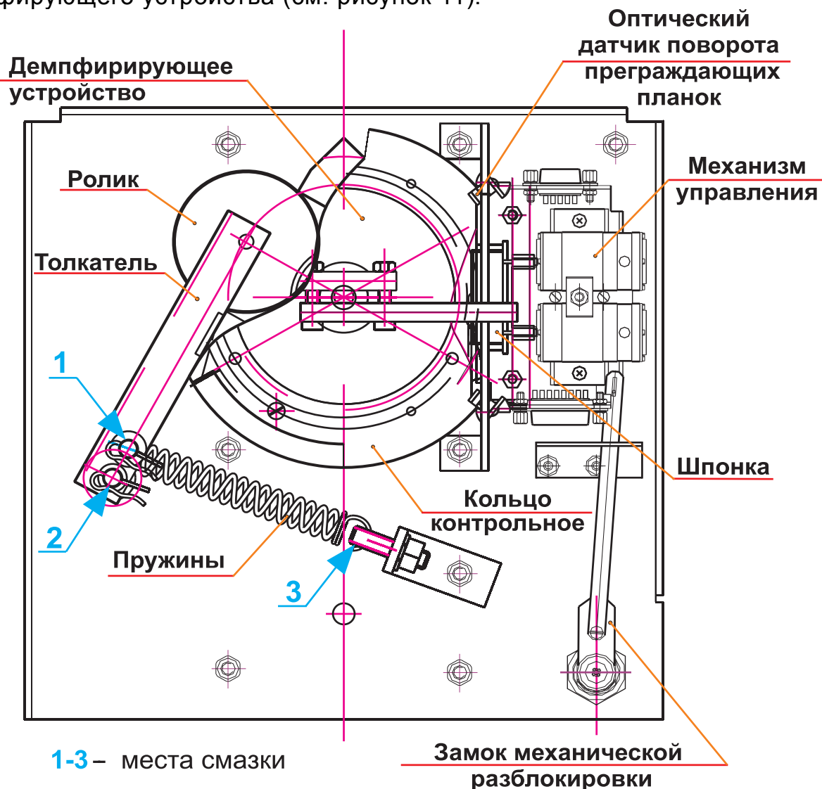
Рисунок 11 - Расположение внутренних деталей и узлов стойки турникета (плата CLB не показана)
