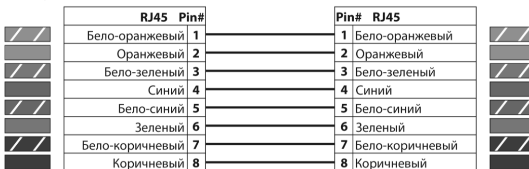
Рисунок 17. Прямая схема обжима кабеля
