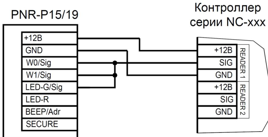
Рисунок 7. Подключение считывателя в режиме Parsec, адрес 1 (внутренний)
