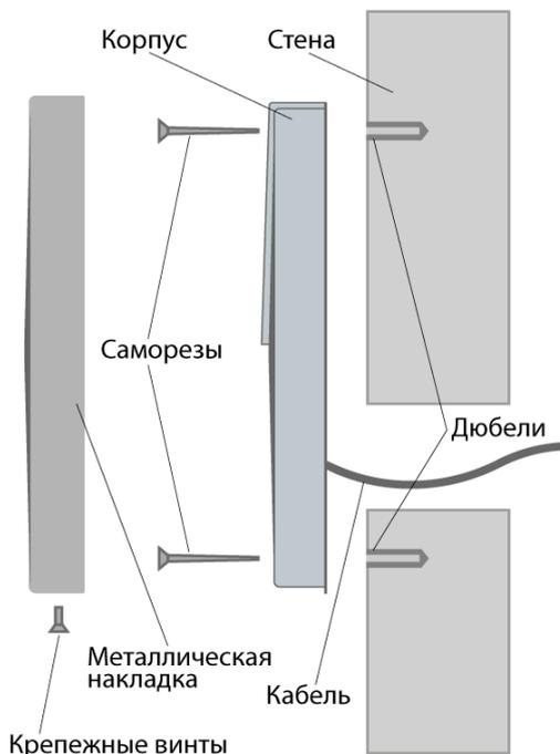
Рисунок 2. Крепление считывателя PNR-P15
