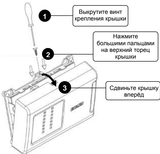
Рисунок 2. Снятие крышки AP8
