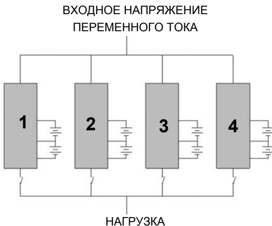
Рисунок 25 — схема подключения изделий в систему параллельного резервирования.
