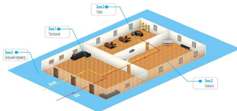
Рис 6. Распределение зон доступа
