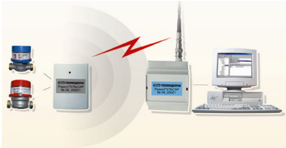
Рисунок 1 - Принцип работы Пульсар 16PM
